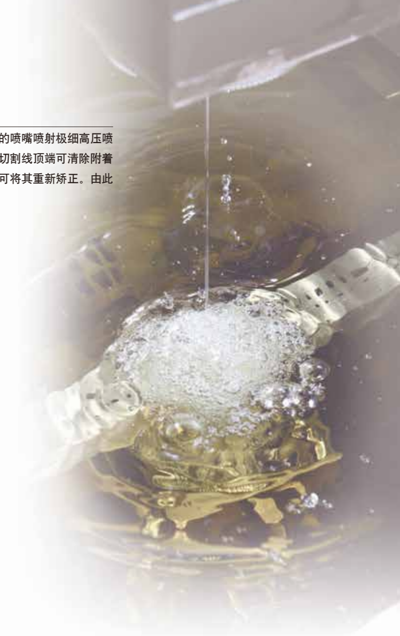
在以 1 mm 的间距接近 φ0.4 mm 的起始孔时进行自动穿线。
